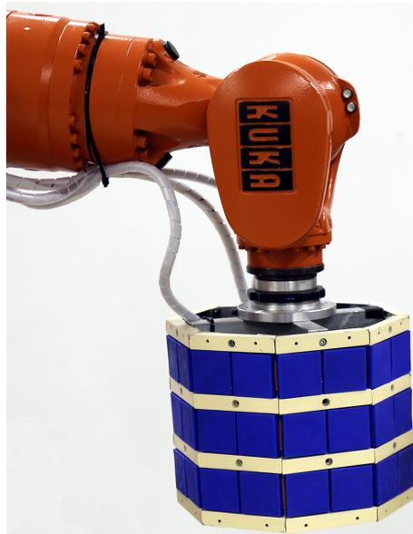
**Abbildung 6.1:** Der End-Effektor, welcher für die Arbeit in diesem Kapitel konzipiert wurde, ist mit einem  $3 \times 16$  Netz von LAMs ausgestattet. (Bildquelle: [16] ©2016 IEEE)
