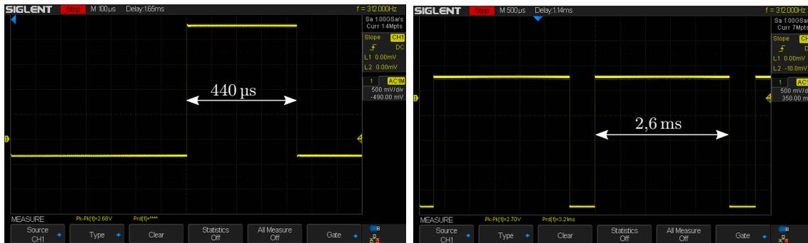
**Abbildung 8.2:** Links: Zeitmessung für die Abtastung der Rohwerte; rechts: Zeitmessung für die Demodulation und Mittelwertbildung; es ergibt sich eine Gesamtzeit von 3,04 ms.
