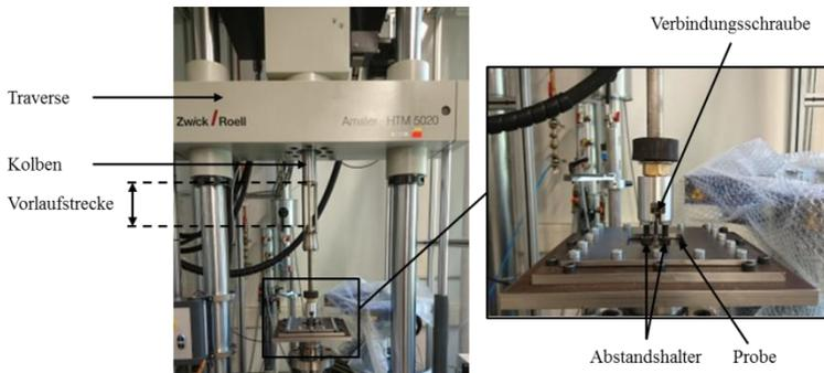
Abbildung 4-3: Aufbau des Hochgeschwindigkeitszugversuches [201]
