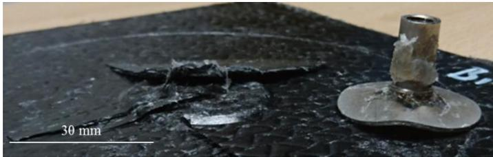
Abbildung 5-9: Bild einer mit 15 m/s geprüften Referenzprobe [201]
