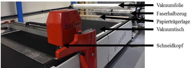
Abbildung 3-1: Schneidisch der Firma Cuttec GmbH Typ CT175N [199]
