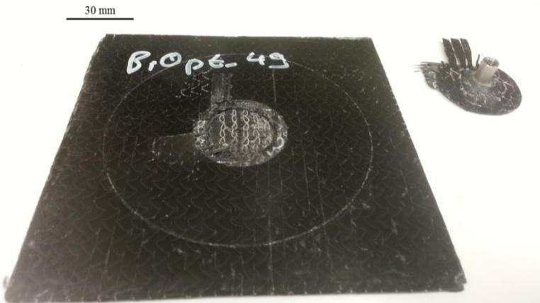
Abbildung 5-34: Bild einer mit 16 J beaufschlagten Probe mit optimiertem Insert – durch das herausgeschlagene Insert war eine nachfolgende Prüfung nicht mehr möglich
