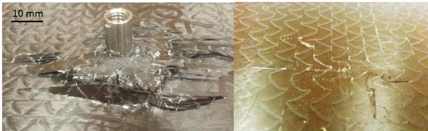
Abbildung 5-13: Schädigungsbilder (Laminatober- und Unterseite) der optimierten Inserts mit einer Prüfgeschwindigkeit von 0,0025 m/s
