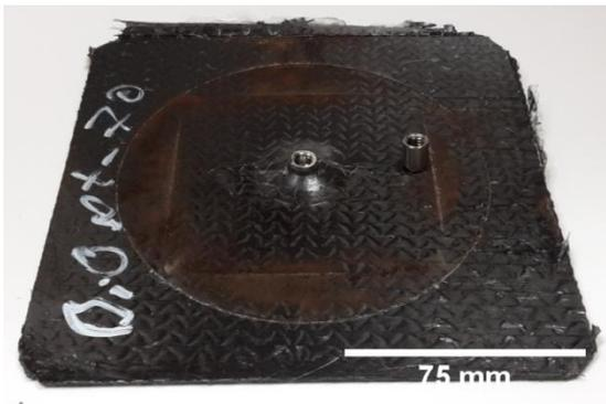
Abbildung 5-29: Versagte Probe mit optimierten Insert im Wöhlerversuch mit  $F_{max} = 4990 N$  [199]
