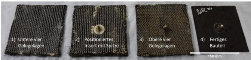
Abbildung 3-3: Einzelne Preformschritte des D30H1 Inserts [199]
