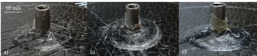
Abbildung 5-47: Exemplarische Schädigungsbilder des Referenzinserts nach a) 10, b) 100 und c) 1000 thermischen Zyklen [201]
