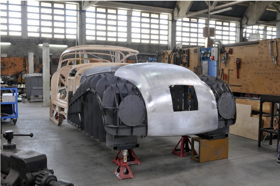
**Abbildung 8:** Über die erstellten 3D-Schablonen wird die Kontur der geformten Bleche kontrolliert und optimiert.
