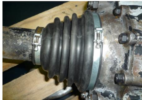
**Abbildungen 9 und 10:** Originalzeichnung der Gummimanschette für die Hinterachse aus dem Archiv (links) sowie Realisierung entsprechend der historischen Vorgaben.
