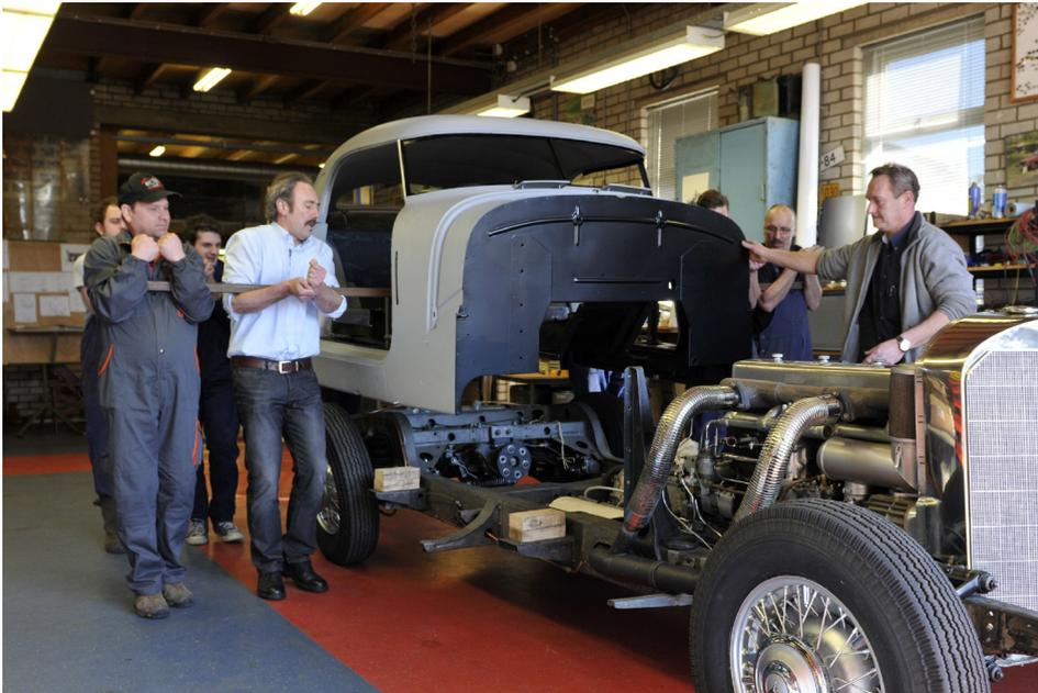
**Abbildung 14:** Die Hochzeit – der Aufbau trifft das Fahrgestell.
