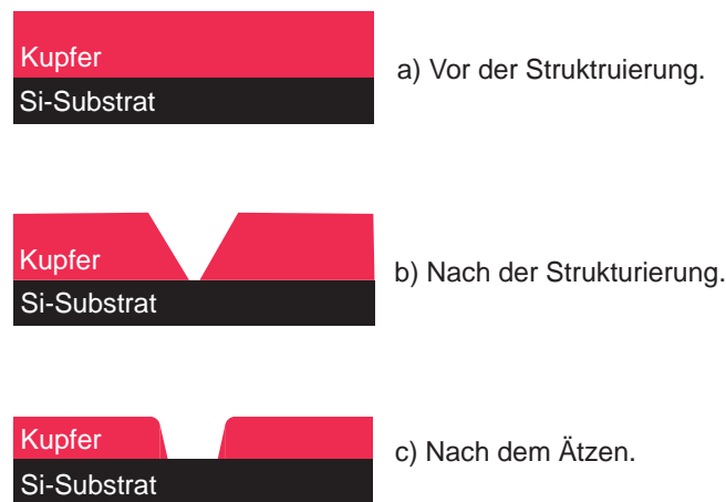
Abbildung 7.4: Schematisch dargestellte Schnitte durch unbehandelte, strukturierte und nach dem Strukturieren geätzte Kupferschichten. Durch die Strukturierung ist eine grabenartige Struktur der Linie entstanden, die keine scharfen Übergang zwischen Substrat und Metallschicht besitzt. In der Mitte der Linie wurde bis zum Substrat strukturiert. Die Metallschichtdicke wächst langsam von der Mitte der Linie bis zu kompletten Metallschichtdicke an. Die Metallfilme wurden geätzt um den flachen Teil des Schichtdickengradienten zu entfernen. Durch den Ätzprozess wird die Filmdicke der Kupferschicht gemindert und die Flanken der Kupferschicht abgerundet. Die Schichtdicken und Linienbreiten sind nicht maßstabsgetreu abgebildet.
