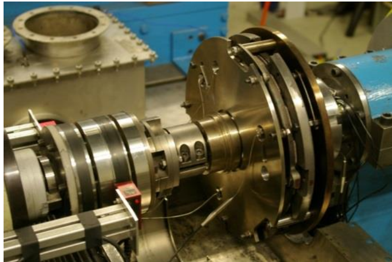
Bild 5-2 Kupplungsscheibe mit Gegenreibpartner auf dem IPEK Trocken-Reib-Prüfstand 135
