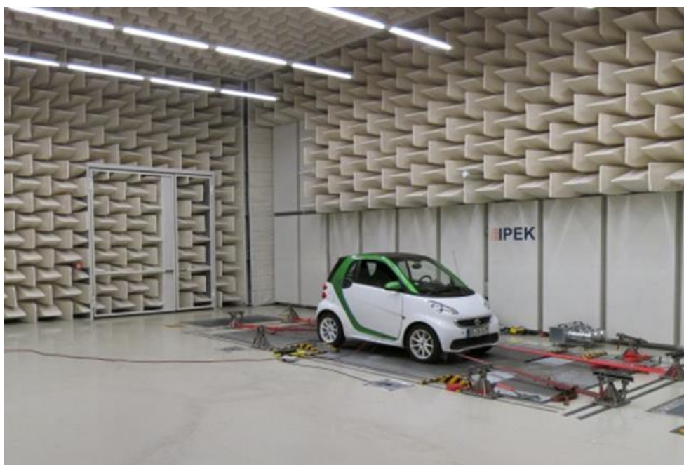
Bild 5-6 Elektrofahrzeug auf dem IPEK Akustik-Rollenprüfstand 144
