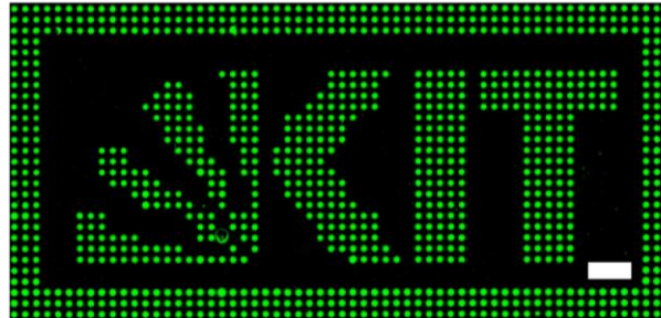
Abbildung 5.20: Fluoreszenzbild von Spots einer synthetischen Aminosäure. Aus [78] entnommen. Es wurde Propargyl-Glycin übertragen und mit einer Click-Chemie-Reaktion angefärbt. Die Länge des Maßbalkens beträgt 1 mm.
