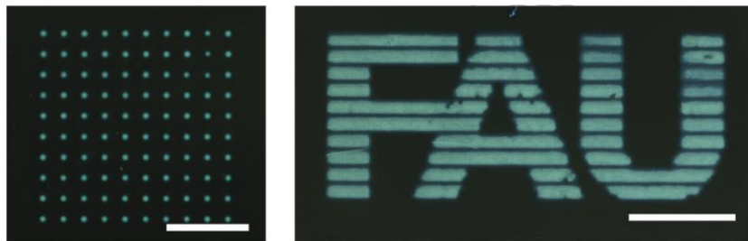
Abbildung 5.25: Fluoreszenzbilder von Spots eines Fluorophors. Entnommen aus [85]. Die Länge des Maßbalkens im linken Bild beträgt 1 mm, im rechten 2 mm.
