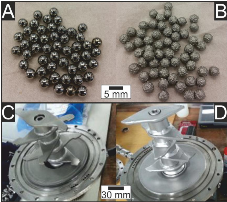
Abbildung 4.2: Vergleich von Verbrauchsmaterial vor und nach dem Mahlen; (A, B) 100Cr6 Kugeln vor und nach mehreren Mahlungen von austenitischem Pulver; (C, D) Rotor vor und nach mehreren Mahlungen von ferritischem Pulver.
