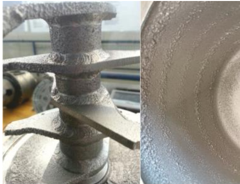
Abbildung 4.3: Anhaften von duktilem Material an den Rotorblättern und in der Mahltrommel.
