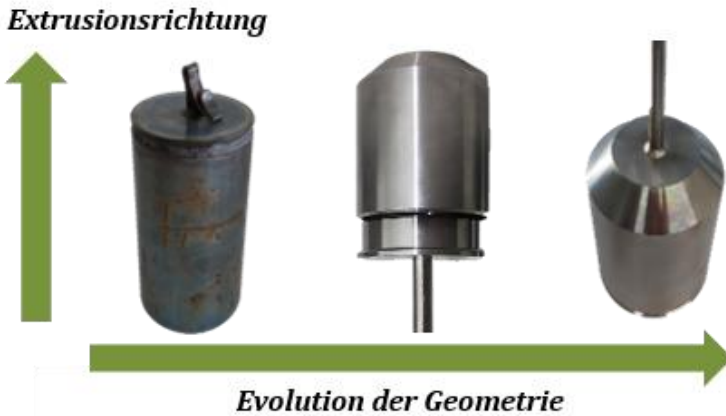
Abbildung 4.5: Veränderung der Kapselgeometrie zur Verbesserung der Ausbeute und Verkleinerung der Totzone.
