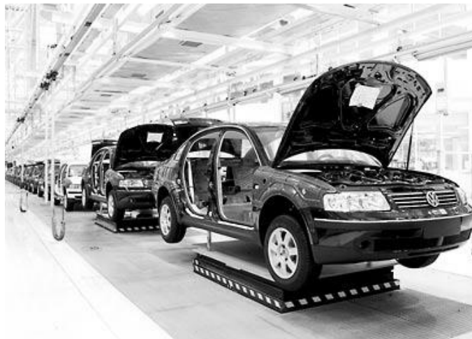
Abbildung 12: Schubskidanlage (Quelle: AFT [AFT-Skid])
