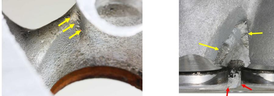
**Abbildung 1.3.: Anriss aufgrund von Schwingbeanspruchung (links) und für die Analyse aufgebrochene Rissfläche (rechts) im Einlassgaskanal nach überlastetem Motorbetrieb aus [HGH<sup>+</sup> 15]**
