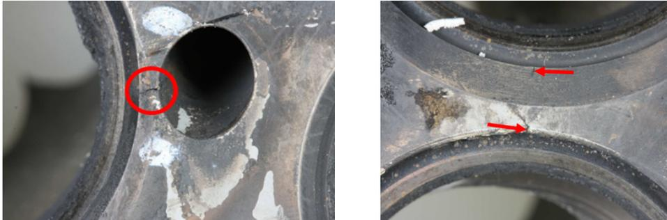
**Abbildung 1.1.: Typisches Schadensbild durch thermomechanische Beanspruchung im Bereich des Ventilsterns aus [HGH<sup>+</sup> 15]**
