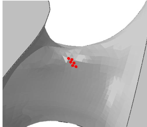
Abbildung 6.4.: Position des virtuellen DMS im FE-Modell an Zylinder 3
