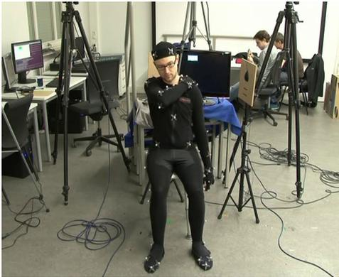
Abbildung 2.2: Multimodale Bewegungserfassung im Labor des H<sup>2</sup>T. Zusätzlich zur markerbasierten passiv-optischen Bewegungserfassung werden Farb- und Tiefenbilder aus verschiedenen Blickwinkeln und Ton mit einem 8-Kanal-Mikrofonarray aufgenommen.
