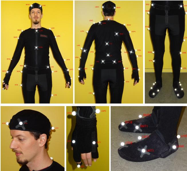
Abbildung 2.5: Positionierung von passiv-reflektierenden Markern am menschlichen Körper gemäß dem *KIT Reference Marker Set* (entnommen aus Mandery et al. 2016c, ©2016 IEEE).
