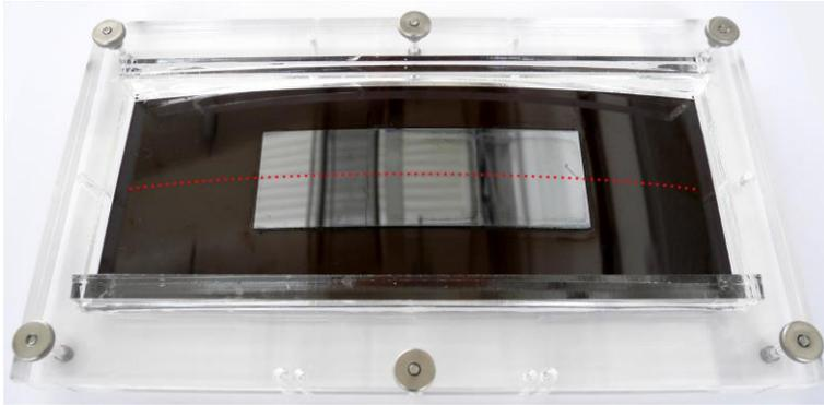
Abbildung 3-13: Foto des Biegerahmens mit 525  $\mu\text{m}$  dicken Siliziumkacheln auf einem 1 mm dicken Trägersubstrat aus Vespel SEK-3000. Das Profil wurde rückseitig entlang der roten Linie gemessen.
