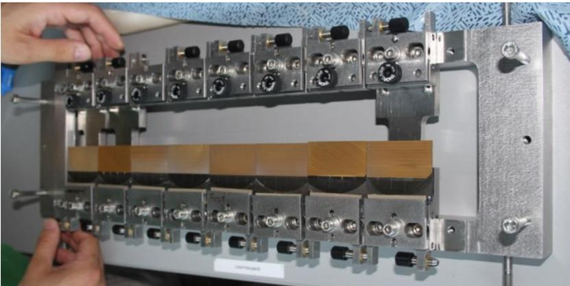
Abbildung 5-13: Foto des Justierschrittes der Gitterkacheln mithilfe des Kachelrahmens.
