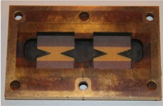
Abbildung 4-8: Maske zur Nullpunktaufnahme mit belichtetem Fotopapier.
