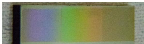
Abbildung 63: Glassubstrat, beschichtet mit Molybdän und 100 nm strukturiertem  $\text{MgF}_2$ . Die spektral abhängige Beugung in Form eines regenbogenartigen Farbverlaufs lässt auf einem Blick erkennen, dass die Strukturierung großflächig und homogen gelungen ist. Für die Funktionsweise der Solarzelle spielt die Beugung jedoch keine Rolle. Abbildung abgewandelt übernommen aus <sup>[173]</sup>.
