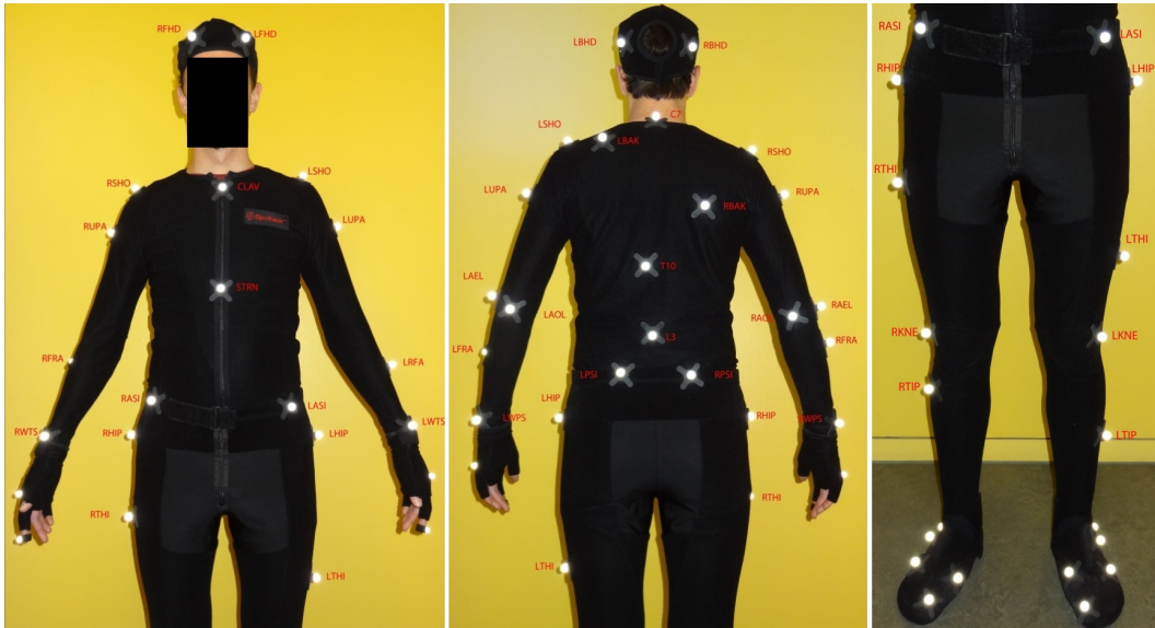
Abbildung 4.2: Vorgeschlagenes Referenzmarkerset für die Aufnahme mit markerbasierten Aufnahmesystemen. [Terlemez et al., 2014] ©2014 IEEE
