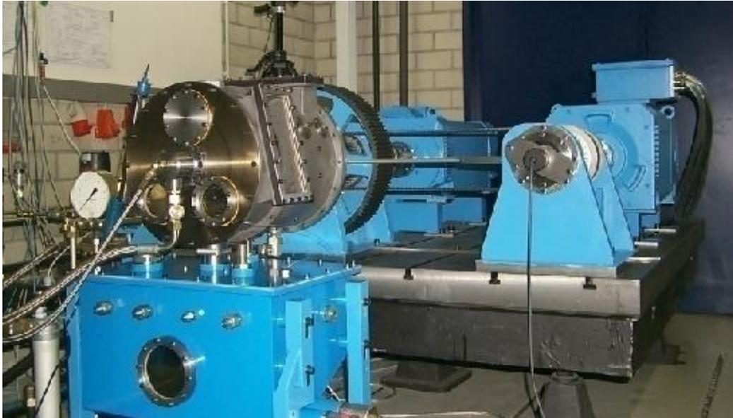
Bild 27: Lamellenkupplungsprüfstand DSP am IPEK
