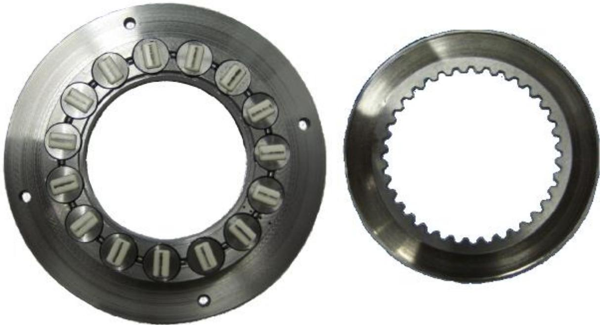
Bild 86: Prüfkopf (links) und Gegenreibeischeibe (rechts) zur systemtribologischen Untersuchung
