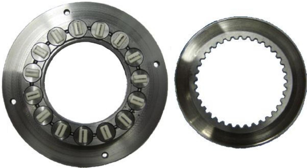
Bild 112: Prüfkopf für systemtribologische Untersuchungen
