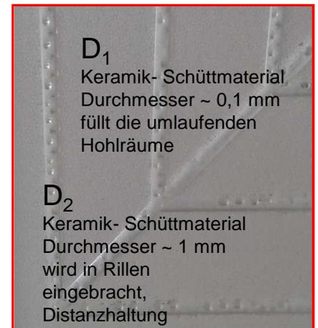
Weitere Beispiele für die Ausgestaltung der Schichten und Zwischenlagen in generativ erzeugten mehrwandigen Bauteilen, unterschiedliche Funktionen und Eigenschaften sind möglich:
