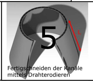
Bereits mittels Draht-Erodieren demonstrierte Abmessungen:
