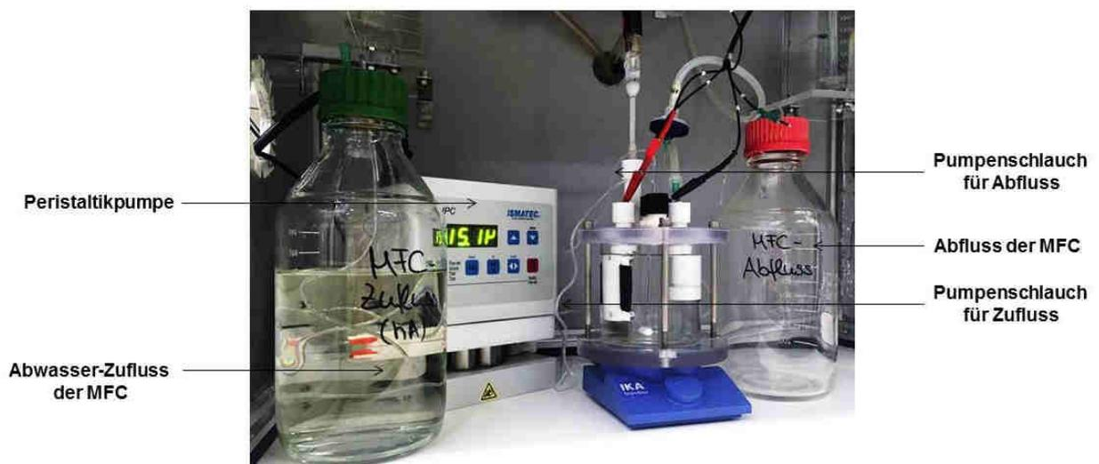
Abbildung 11: M3C-Reaktor (280 ml) im Durchfluss-System. Das Bild zeigt den angeschlossenen Reaktor während der Messung mit Potentialkontrolle durch die Referenzelektrode, Begasung und kontinuierlichem Rühren. Zusätzlich wird hier über eine Peristaltikpumpe kontinuierlich frisches hA-Abwasser zugepumpt (Abwasser-Zufluss) und ebenso wieder aus dem Reaktor abgeführt (Abfluss der MFC).
