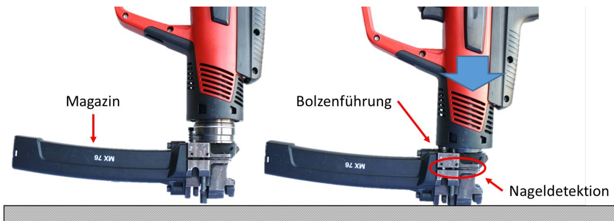
Abbildung 7-2: Sicherheitsmechanismus über das Anpressen des Geräts an den Untergrund 419
