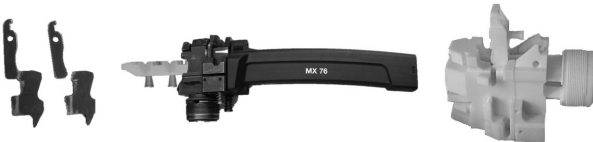
Abbildung 7-6: Originalteile der Nageldetektion (links), Baugruppe des Magazins und der Bolzenführung mit Nagelstreifen (Mitte) und ein gedrucktes 3D-Modell (rechts) 424
