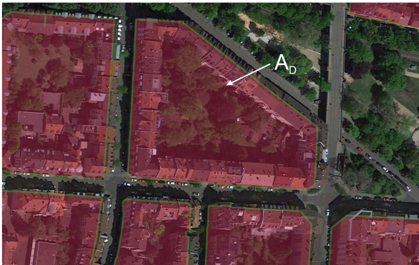
Abbildung 6.33: Totfläche A_D am realen Beispiel.
