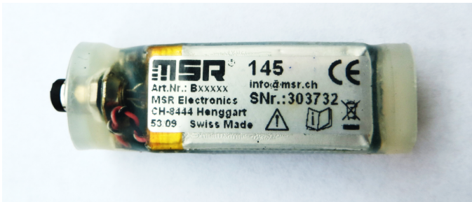
Abbildung 3.2: Sensor für relative Luftfeuchtigkeit: MSR145.
