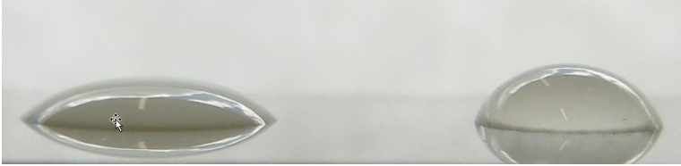
Abbildung A.15: Aufnahme der Tropfenformen von Salzlösung (links) und Wasser (rechts) auf PE mit einem Tropfenvolumen von 30 \mu\text{l} .
