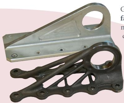
Große Potenziale werden in der **Luftfahrtindustrie** gesehen. Durch seine bionische Struktur erreicht dieser durch **Lasersintern** gefertigte Kabinenhalter (unten) eine Gewichtseinsparung von über 30% im Vergleich zu seinem konventionell hergestellten Pendant (oben), erfüllt aber dieselben Vorgaben hinsichtlich Funktionalität und Festigkeit.
