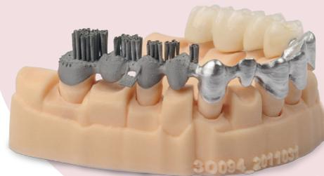
In der **Dentalindustrie** gehört das **Lasersintern** bereits zu den Standardverfahren. Die Abbildung zeigt drei Phasen des additiven
