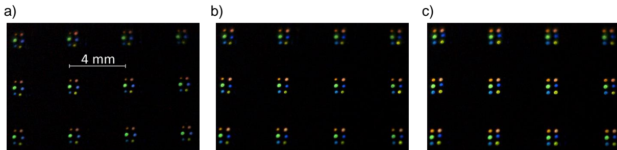
Abbildung 5.16: Foto der Proben unter UV-Anregung: a) P1: 0,5 s Shutterzeit, b) P2: 1 s Shutterzeit bzw. doppelte Materialmenge gegenüber P1, c) P3: 2 s Shutterzeit bzw. vierfache Materialmenge gegenüber P1. Die Variation der Shutterzeit erzeugt somit künstliche Fertigungstoleranzen hinsichtlich der abgeschiedenen Materialmenge.
