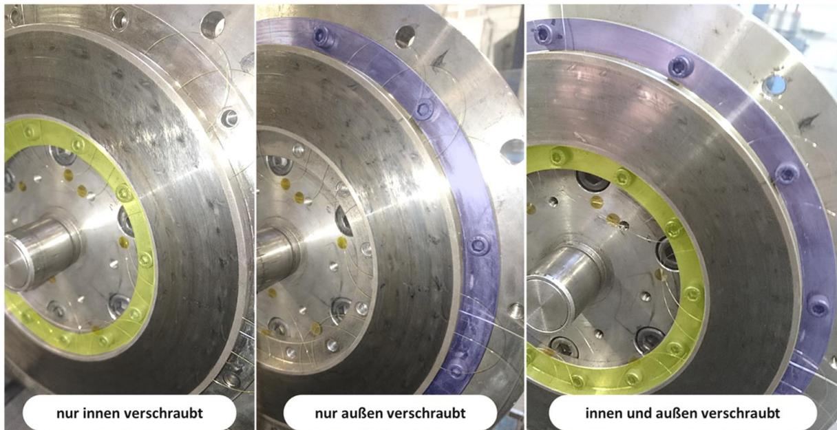
Abbildung 6.15 Unterschiedliche Anschraubsituationen der Anpressplatte<sup>289</sup>
