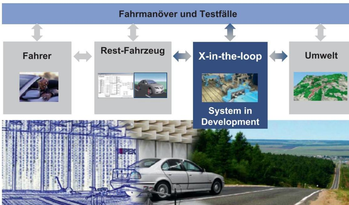
Abbildung 2.6 Anwendung des IPEK-X-in-the-loop-Ansatz auf die Antriebsstrangentwicklung<sup>39</sup>
