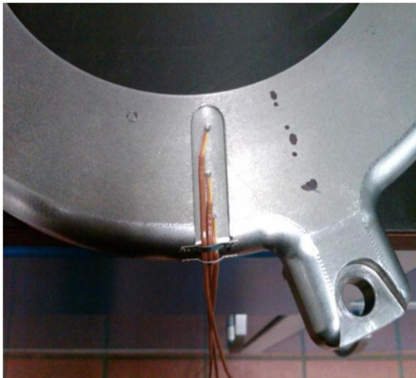
Abbildung 2.57 Applizierte Thermolemente in der Anpressplatte C1<sup>153</sup>
