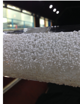
(b) Raue Schicht (Sandpapier) mit h_r/D_{Zyl} = 2142 \cdot 10^{-5}
