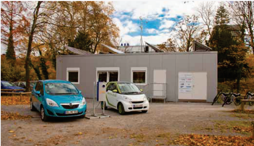
Beim Energy Smart Home Lab im Universitätsbereich des KIT werden Elektrofahrzeuge als mobile Energiespeicher genutzt.
