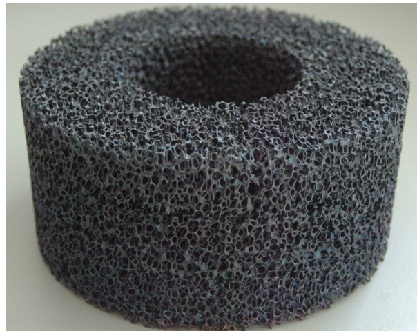
Abbildung 4.4: Eingesetztes poröses Material - 10 PPI SiSiC
