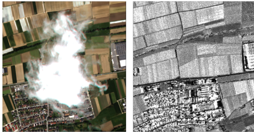
Abbildung 1.1.: Gegenüberstellung eines Ausschnitts aus einem optischen Satellitenbild (hier: WV-2, links) mit einem identischen Ausschnitt aus einem SAR-Satellitenbild (hier: TSX, rechts).
