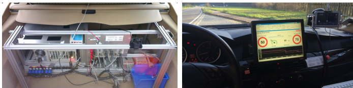
Bild 6.2: Abbildung links zeigt den Kofferraum mit Messtechnikrechner (links), Power Management (unten) und CAN Verteiler (rechts) [217]. Abbildung rechts zeigt aus Fahrersicht den Bildschirm des Messtechnikrechners mit HMI (mittig) und das Navigationssystem (rechts oben)[260]
