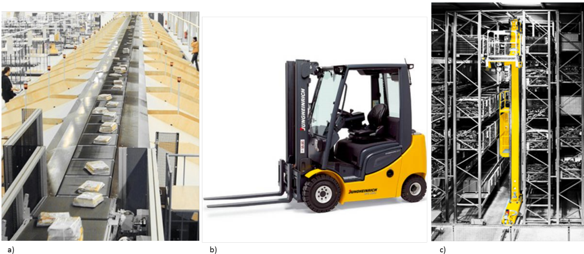
Abbildung 1.3.: a) Stetigförderer (Interroll AG), b) Flurförderfahrzeug (Jungheinrich AG), c) RBG (Dambach Lagersysteme GmbH & Co. KG)
