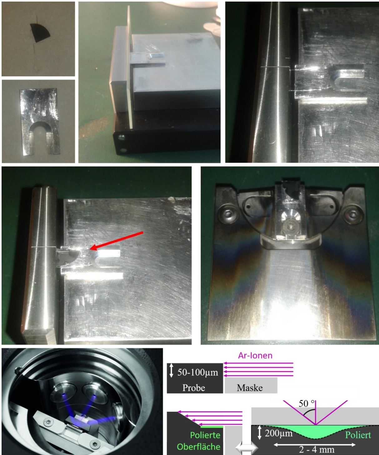
Abbildung 24: Bildercollage für die Präparation von Querschnittsproben mit einer ‚EM TIC3X‘ von Leica. Der rote Pfeil markiert das Sandwich aus Glas-Probe-Glas auf der Probenhalterung, die in die Ätz-Anlage eingebaut wird. Unten ist schematisch gezeigt, wie der polierte Querschnitt entsteht und nach der Bearbeitung aussieht. Das linke Bild der unteren Reihe wurde aus [164] entnommen.
