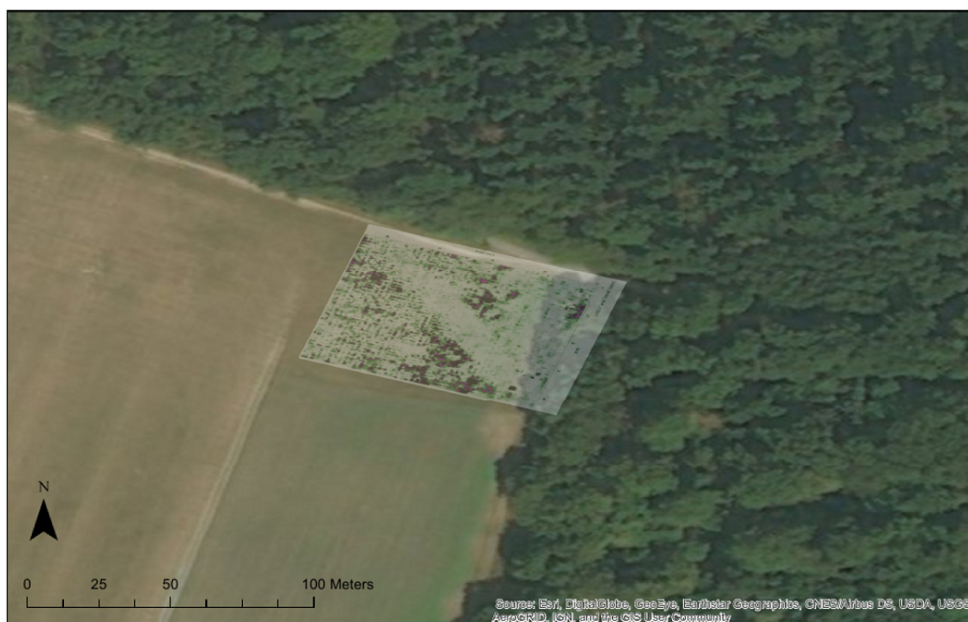
Abbildung 3.5.: Georeferenzierter Tiefenschnitt des 3D-GPR-Modells (Wegscheider, 2017). Die Geländekarte stammt aus einem ESRI-Datensatz. Eine helle Anomalie (hier ist die Amplitude der elektromagnetischen Wellen neutral) markiert den Verlauf des Grabens.
