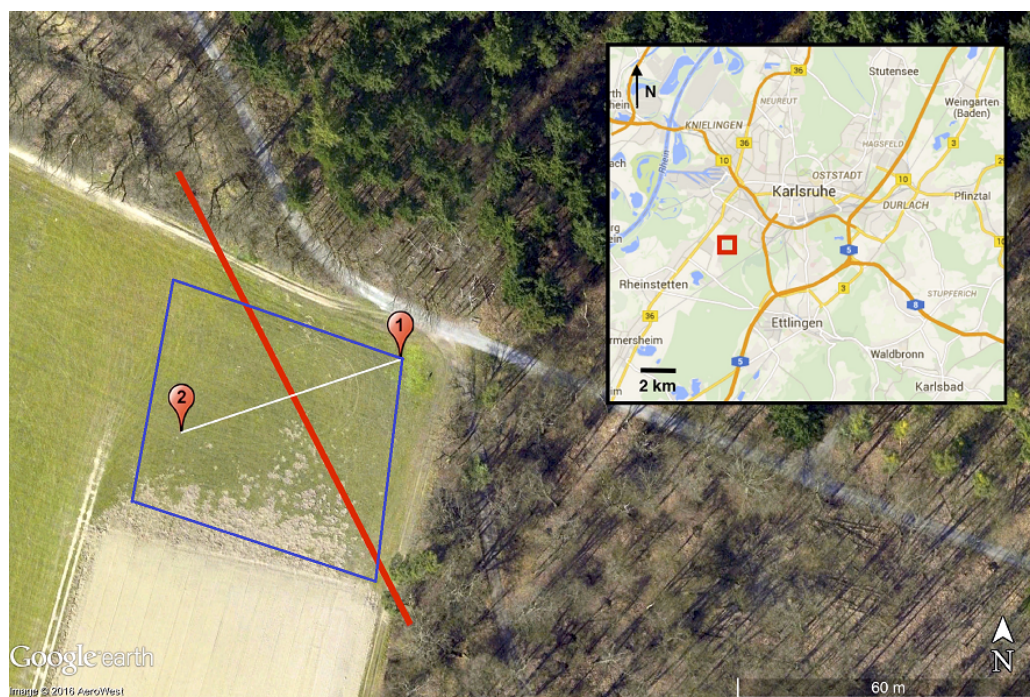
Abbildung 3.2.: Lageplan der Ettlinger Linie bei Rheinstetten (nach Wittkamp, 2016 und Wegscheider, 2017). Der vermutete Verlauf der Ettlinger Linie ist durch eine rote Linie markiert. Die Markierungen 1 und 2 kennzeichnen das seismische Profil, welches für die individuelle und simultane Wellenformversionen von Rayleigh- und Love-Wellen verwendet wurde. Des Weiteren ist das Messfeld für die Aufnahme der Georadar-Daten blau markiert. Das Kartenmaterial wurde Google Maps und Google Earth entnommen.
