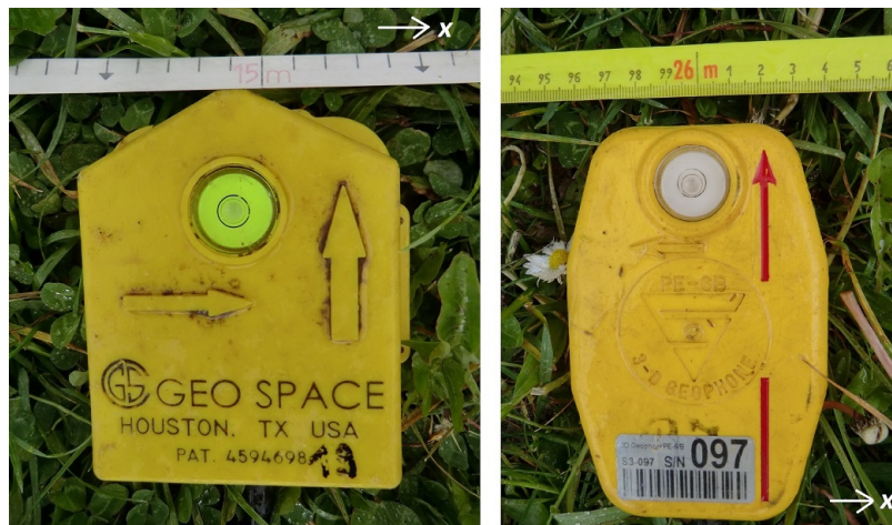
Abbildung 5.2.: Während der Erfassung der 9-C Daten verwendete Geophontypen (Fotos: Svenja Schaneng). Links: Geophon des Herstellers GeoSpace. Rechts: Geophon des Herstellers Sensor. Bei der Installation der Geophone im Untersuchungsgebiet ist darauf zu achten, dass die Geophone vertikal in den Untergrund gesteckt werden. Dies kann über kleine Libellen auf der Oberseite der Geophone kontrolliert werden.
