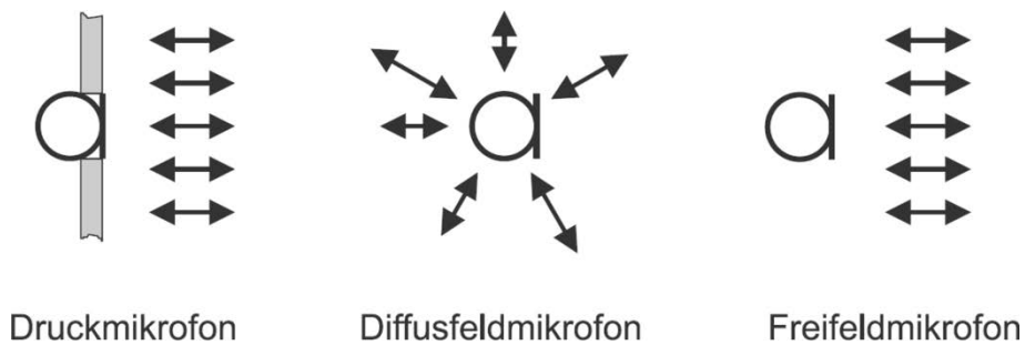
Bild 18: Schematische Darstellung von Druck-, Diffusfeld- und Freifeldmikrofon 76
