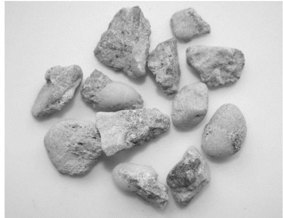
Abb. 6: Betonsplitt ca. 16 mm Korngröße
