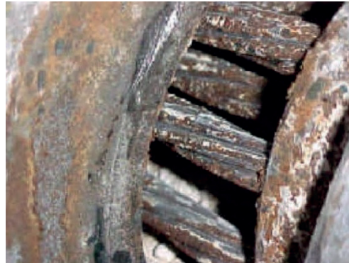
Abb. 2-10: Mid-Bay-Brücke (USA): Ausgebautes, nicht vollständig verfülltes und zum Teil korrodiertes externes Spannglied (links) [82], nicht verfüllter Ankerbereich mit Korrosionsschäden (rechts) [77]
