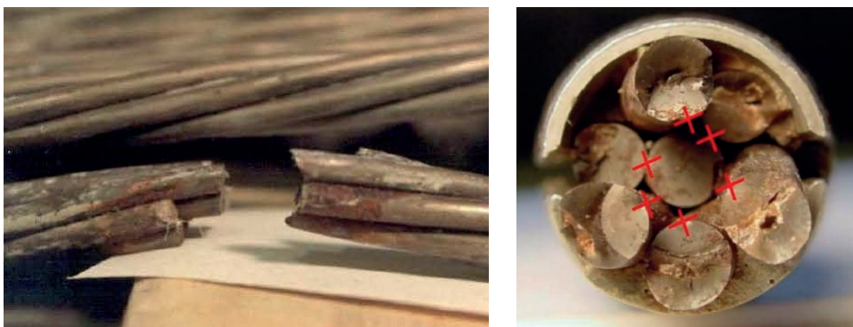
Abb. 2-20: Ermüdungsrisskorrosion (links) und Reibkorrosion (rechts) bei einer Litze (Kreuze markieren die Stellen der Risseimbildung) [50], [77]
