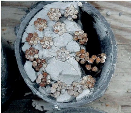
Abb. 2-10: Mid-Bay-Brücke (USA): Ausgebautes, nicht vollständig verfülltes und zum Teil korrodiertes externes Spannglied (links) [82], nicht verfüllter Ankerbereich mit Korrosionsschäden (rechts) [77]
