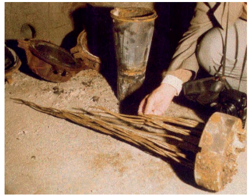
Abb. 2-9: Infolge Korrosion im Bereich des Ankers gerissenes externes Spannglied in der Brücke über den Durance, Frankreich (links), Verankerung nach dem Ausbau (rechts) [60]
