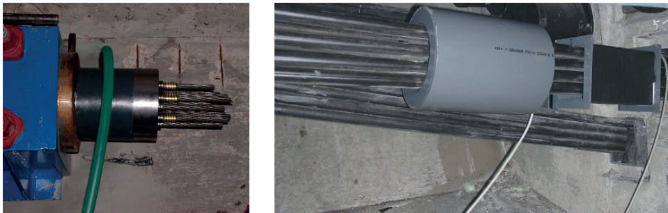
Abb. 4-8: Magnetoelastischer Sensor zwischen Ankerkopf und Ankerplatte (links) [159]; Beim Einbau des neuen Bandspanngliedes eingesetzte runde und eckige Sensoren (rechts)
