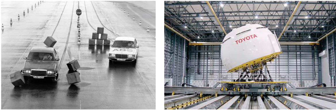
Bild 2-23: Streckenerprobung auf dem Testgelände (links) 252 , Fahrzeug-Fahrdynamiksimulator von Toyota (rechts) 253
