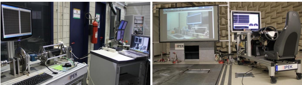
Bild 7-1 Prüfstandsvernetzung Mini-HiL (links) und Fahrsimulator (rechts)
