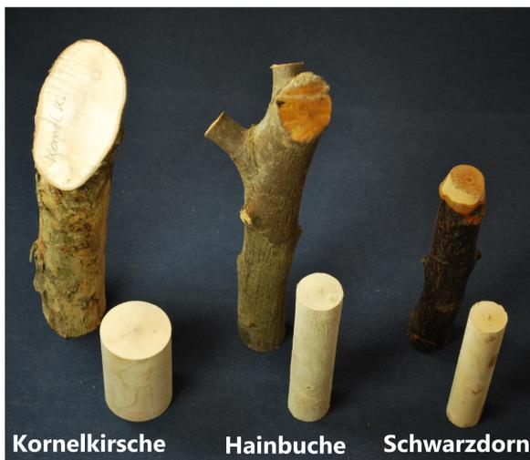
Aus den Stöcken wurden zylindrische Probekörper mit dem Durchmesser  $d$  und der Länge  $L$  gedreht und deren Volumen berechnet
