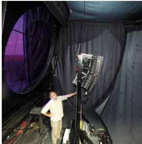
Fluoreszenzteleskope des Auger-Observatori- ums zur Beobachtung von Teilchenkaskaden in der Atmosphäre von innen (Foto links) und außen (Foto unten)
