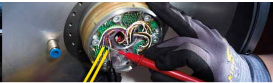
Überprüfung des Telemetriemoduls am Prüfstand von Laura Cordes
