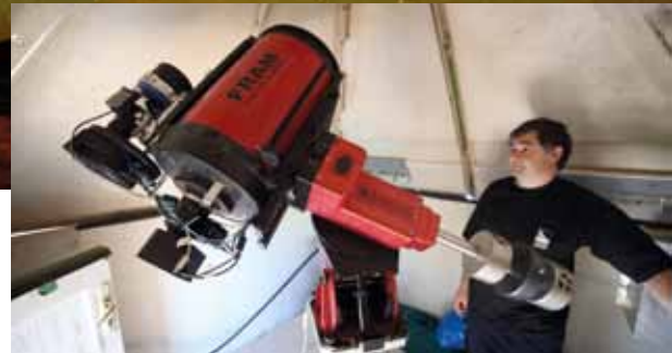
FRAM-Teleskop zur automatischen Ver- messung der Licht- absorption in der Atmosphäre
