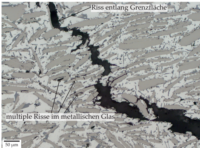
Abbildung 5.117: Detailausschnitt 1 des Risses im Verbund 40-100 nahe der Risspitze in der gekerbten Vierpunktbiegeprobe nach dem Versuch.
