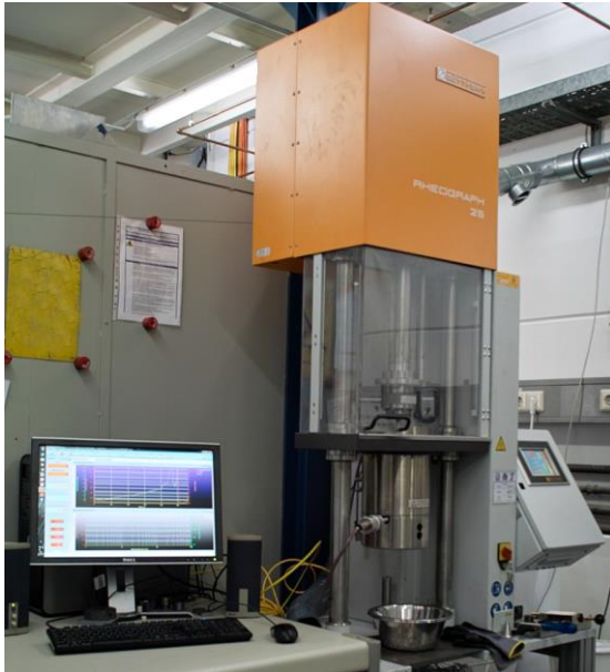
Abbildung 4.8: Kapillarrheometer Rheograph 25 der Firma Göttfert Werkstoffprüfmaschinen GmbH
