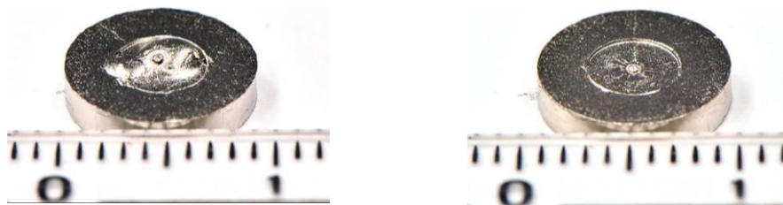
Abbildung 5.26: Gesinterte Triboscheiben; Blasenbildung im Sinterschritt bei geringer Vorentbinderungsdauer (30 min, links) und defektfreies Bauteil nach langer Vorentbinderungsdauer (1 h, rechts); 65 Vol % 17-4PH; Heizrate 6 K/min
