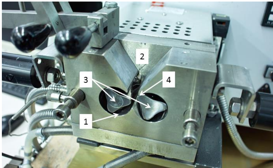
Abbildung 4.3: Aufbau der Knetkammer des Messkneters W50 EHT von Brabender GmbH & Co. KG
