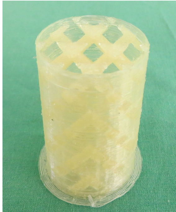
Abbildung 7.5: Erster erfolgreicher Druck eines PVA Funktionsmusters.
