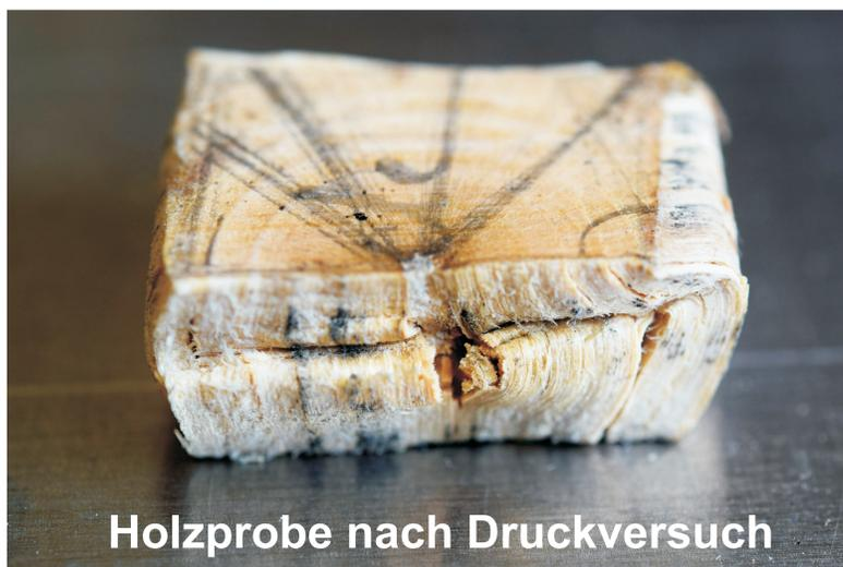
Eine Phänomenologie des Druckversagens bei einem Holzquader der Größe: 12 mm (axial) x 12 mm (radial) x 17 mm (tangential):
