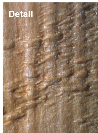
**Druckseite:** Blick auf die konkave Druckseite der Probe mit stark gestauchten Holzfasern.
