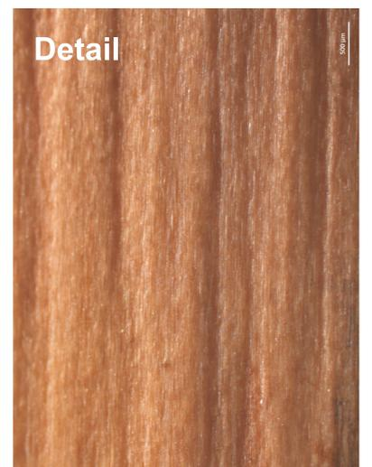
**Zugseite:** Blick auf die konvexe Zugseite der Holzprobe mit axial relativ glatter Oberfläche.
