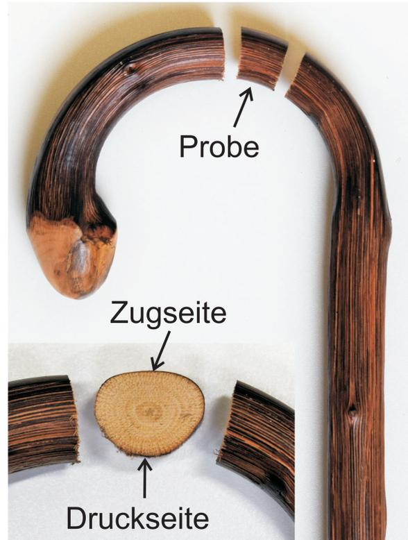
Entnahme einer **Holzprobe** aus dem gekrümmten Bereich des Stockes. Innenseite der Biegung entspricht der „Druckseite“, Außenseite = „Zugseite“.
