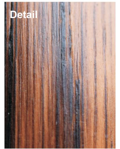
**Zugseite:** Blick auf die konvexe Zugseite der Holzprobe mit axial relativ glatter Oberfläche.
