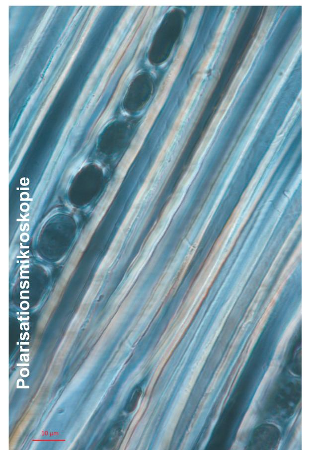
Oberflächennaher Tangentialschnitt der **Zugseite** hier ohne Mikrofibrillenstauchungen in den Zellwänden und ohne kollabierten Holzstrahlzellen.
