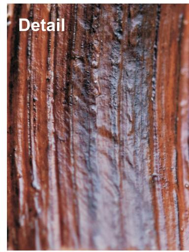
**Druckseite:** Blick auf die konkave Druckseite der Probe mit gestauchten Holzfasern.
