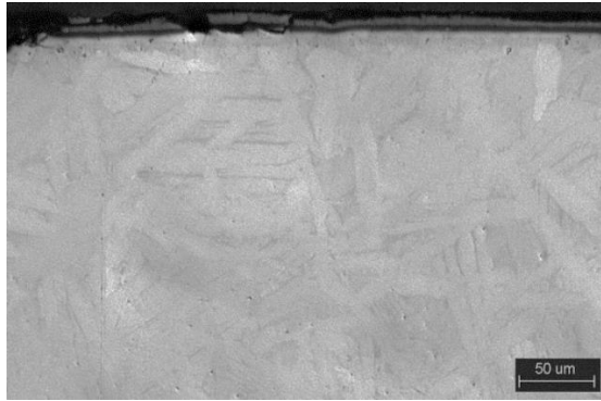
1010 mm, 225°; ZrO 2 : 8 μm; α-Zr(O): 8 μm
