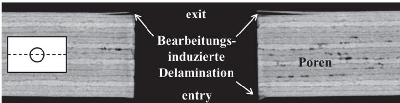
Abbildung 89: CT-Längsschnitte durch eine gebrochene OHB-Probe aus HP-CFK 268 g/m<sup>2</sup> [0/45/90/-45]<sub>2s</sub>, gebohrt in Maschinenkonfiguration B ( $\theta = 85^\circ$ ) nach  $L_f = 1,4$  m ( $DF_{A,exit} = 50$  %): a) Bohrungsrand, b) Bohrungsmitte.
