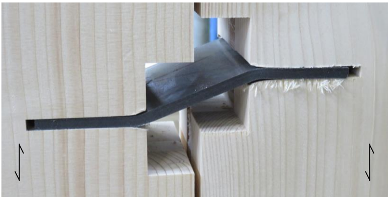
Bild 6-12 W2_1. Planmäßiges Versagen der dissipativen Stahlblechverbinding. Plastisch verformtes Stahlblech mit deutlich ausgeprägten Fließlinien und kleinen Bereichen plastischer Druckverformungen im BSP
