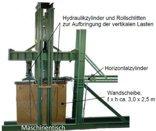
Bild 6-2 Karlsruher Wandprüfstand mit eingebauter Wandscheibe [49]
