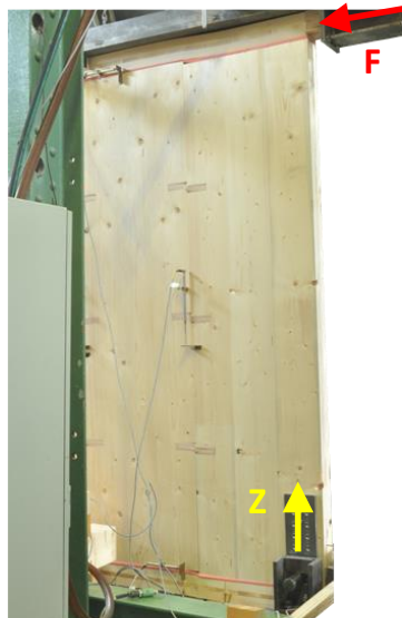
Bild 6-8 W1_2. Konzentration der Relativverschiebungen auf die erste Schmalseitenfuge neben dem zugbeanspruchten Zuganker
