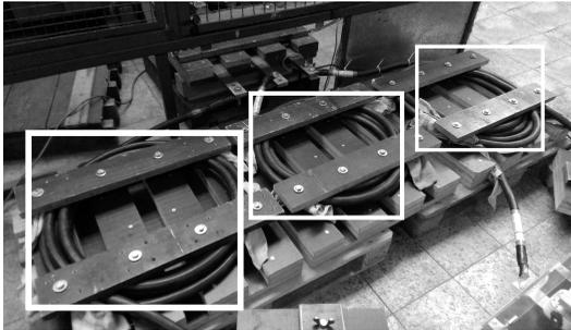
**Abbildung 3.21:** Fotografie des Aufbaus der drehstromseitigen Drosseln  $L_{AC}$
