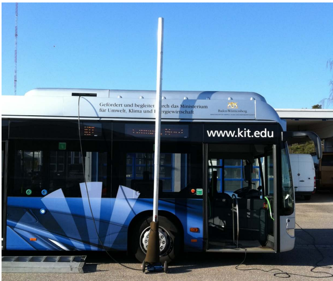
Abbildung 9: Spezielle Einrichtung zum Abblasen der 30kg H 2 aus den Fahrzeugspeichern
