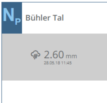
Abbildung 3: Exemplarische Darstellung einer sogenannten Mini-Kachel des FLI-WAS 3 Systems. Es wird der Niederschlagswert des aktuellsten 5-minütigen Intervalls dargestellt.
