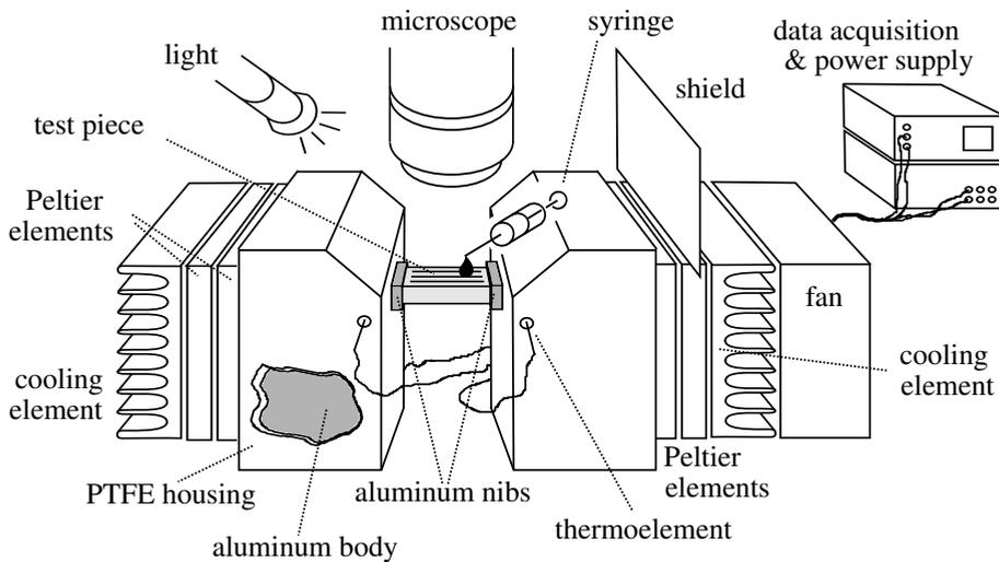
Figure 3.10.: Experimental setup
